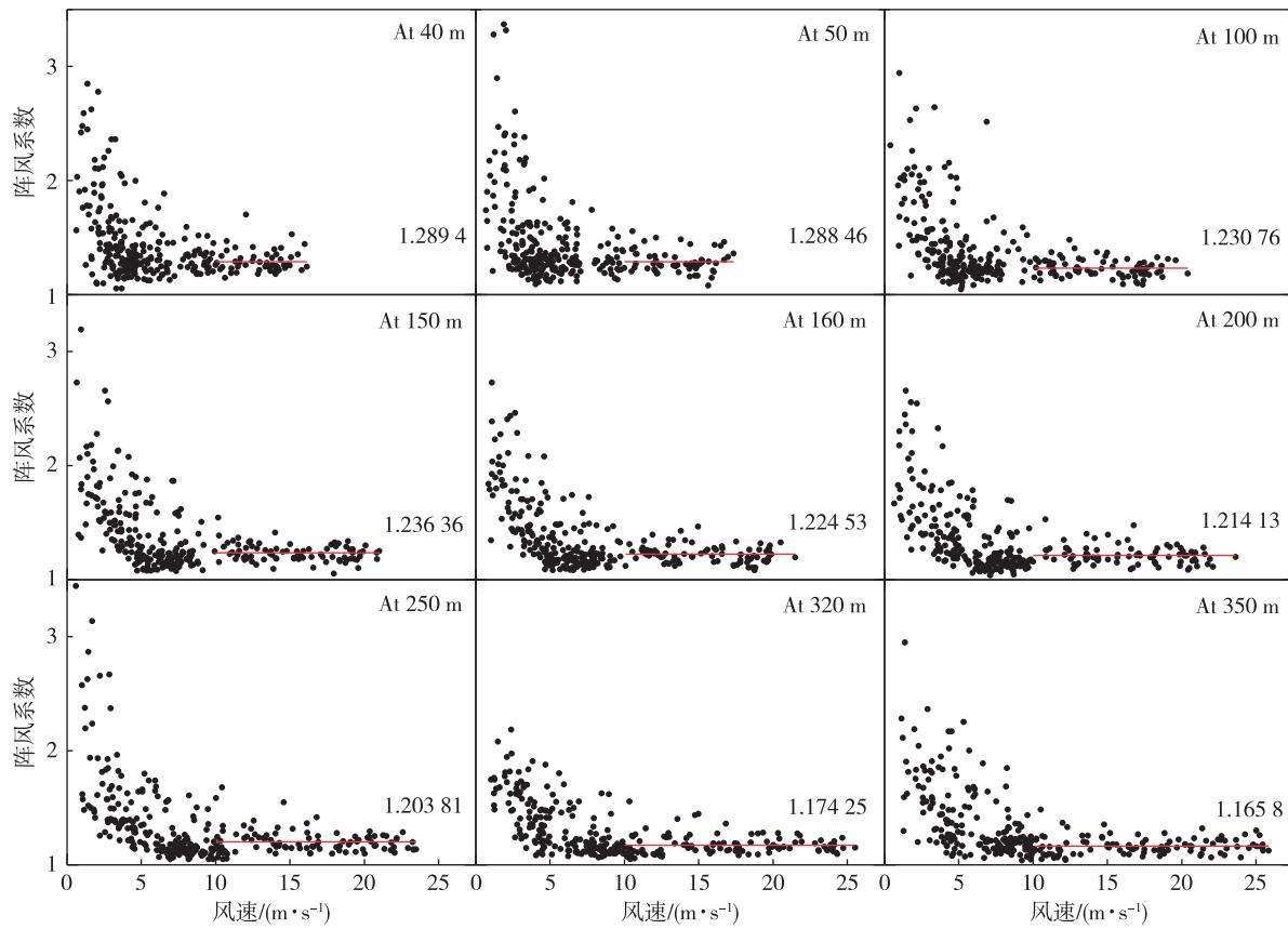
图9 台风“妮姐”影响期间不同高度上阵风系数与风速的关系
