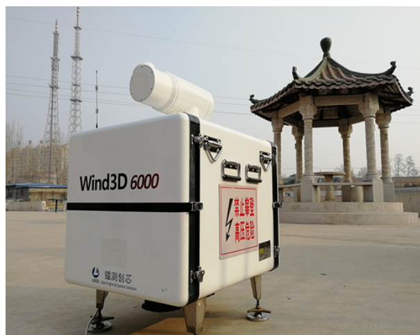
图1 安装于绥中的相干多普勒测风激光雷达 Wind3D 6000
